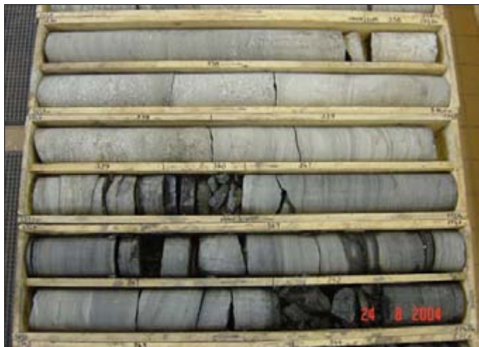
Abb. 6: Bohrung Oelsnitz 1A/2003, Teufe 568,0 bis 574,0 m, Einteilung des Kernmaterials in die Lithoeinheiten 338 bis 342 nach JUNGHANNS (2004a)
