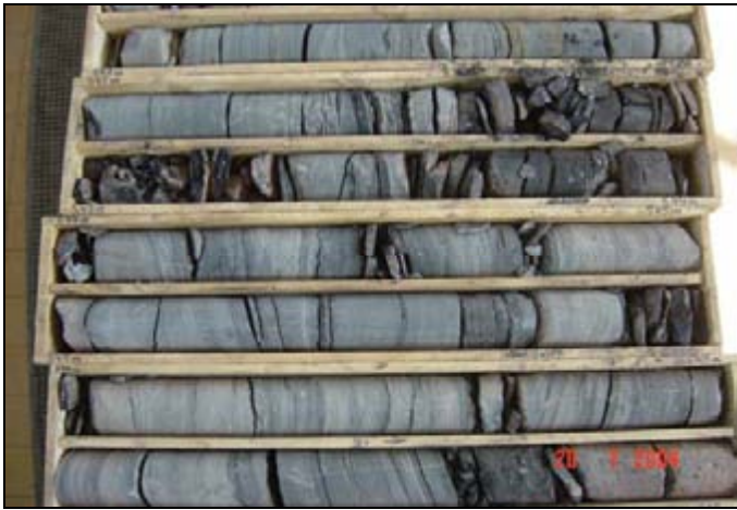
Abb. 21: Bohrung Oelsnitz 1A/2003 Teufenbereich 541,0-548,0 m Neuflöz 2: 542,6-543,30 m, 543,55-544,00 m, 544,47-544,55 m, 545,64-545,77 m, 545,90-546,05 m, 547,59 547,78 m, 548,93-548,97 m
